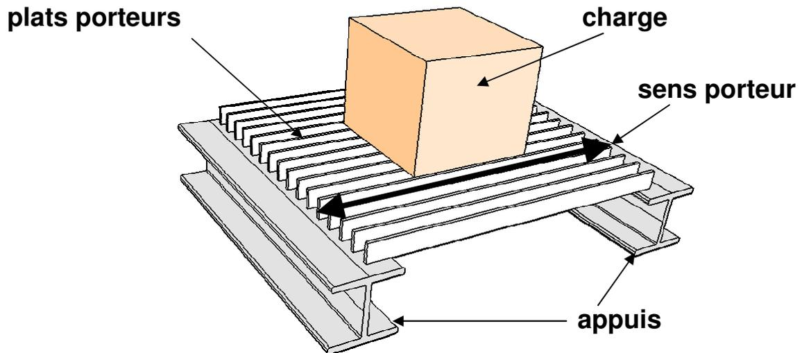
**Si le caillebotis repose sur 2 côtés**, comme sur le dessin ci-dessus, le sens porteur est naturellement la distance entre les deux appuis (la longueur des plats porteurs, dont chaque extrémité repose sur un appui).
